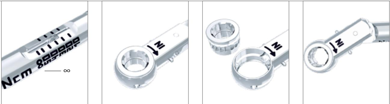
Il punto di pressione per il preciso rilascio del torque è solo sulla testa della vite di registro. Quando viene raggiunto il torque impostato, la boccola graduata si piega attorno all'asse nella testa del cricchetto. Lo scatto è udibile e percepibile. Dopo lo scatto del torque, NON premere oltre - il cricchetto potrebbe danneggiarsi.
