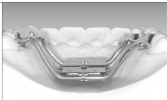
Le viti hyrax®/hyrax® click (Hygienic Rapid Expansion Screw) sono viti speciali create per l'espansione rapida del palato. Devono essere posizionate „sospese“ e discoste almeno 1-2 mm dalla volta palatina. Per evitare l'effetto leva, assicurarsi che siano parallele al piano oclusale.
