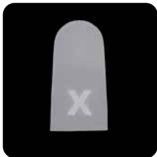
Fig. 4: Provino di cottura con cottura corretta
