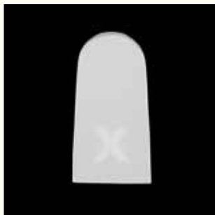
Fig. 5: provino cotto a temperatura troppo bassa
