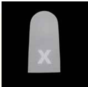
Fig. 4: provino cotto alla temperatura corretta
