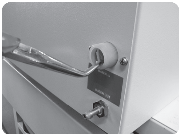
Fig. 5 : positionnement du filtre à eau du raccord d'alimentation en eau
