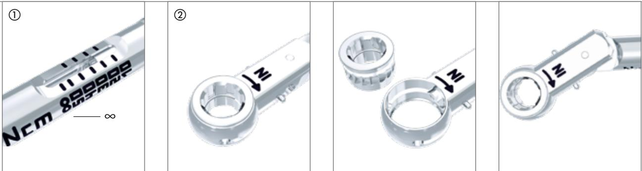
Le point de pression pour un déclenchement exact du couple se trouve exclusivement sur la tête de l'écrou de réglage. Une fois que le couple réglé est atteint, la douille graduée se plie autour de l'axe dans la tête de la clé. Le déclenchement est parfaitement audible et perceptible. Une fois que le couple a été déclenché, NE PLUS exercer de pression – la clé risque d'être endommagée.
