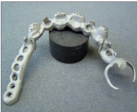
Abb. 17: Abgetrenntes und abgestrahltes Gussobjekt.
