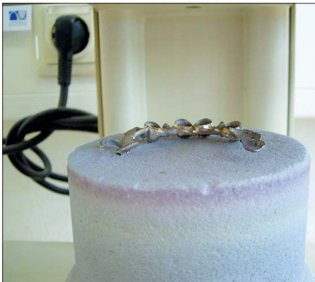
Abb. 16: Abgestrahltes Gussobjekt nach dem Entspannen.
