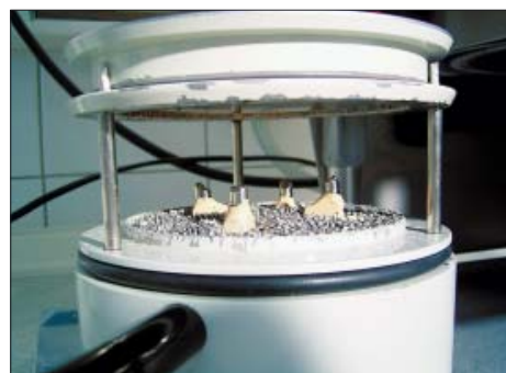
Abb. 11: Tiefziehen der Primärteile.
