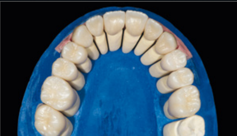
13 - 15 Nach dem Sinterprozess (1500 °C, 2 h Haltezeit) sehen die Kronen wie hier dargestellt aus. Aufgrund des Multilayer-Zirkonoxids und dem zusätzlichen Einfärben sind bereits Farbverläufe zu erkennen
