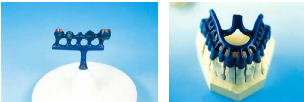
Abb. 1: Anstiftsystem für den Titanguss (Rematitan ® -System, Dentaforum)
