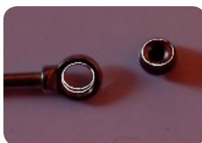
fig. 6 Diamètre intérieur des œillets par rapport au diamètre extérieur des pivots
