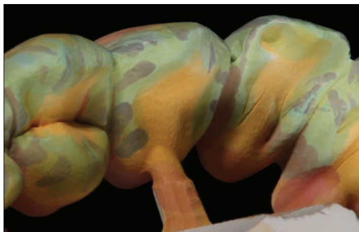
Fig. 23 : Coloration d'une zircone blanche par la technique dite des aquarelles
