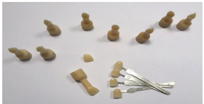
Fig. 26 : Echantillons de céramiques cosmétiques et de zircone colorées utilisées pour optimiser les teintes entre ceraMotion® Zr et zircone Nacera
