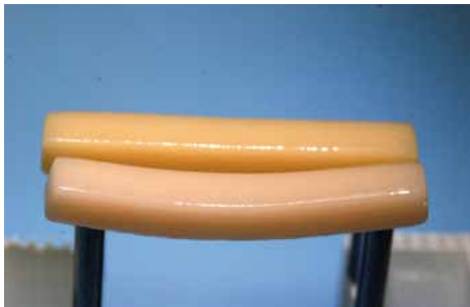
Fig. 2 Barretta di ceraMotion® Zr (in alto) dopo 8 cotture comparata a una barretta di una ceramica feldspatica tradizionale.
