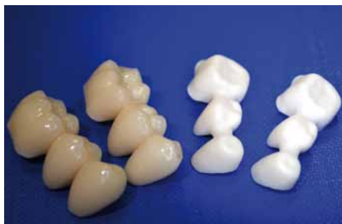
Fig. 9 Ponti rivestiti in ceramica (a sinistra) e non rivestiti (a destra) utilizzati per ottimizzare il comportamento agli shock termici.
