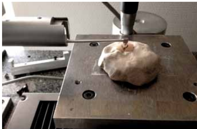
Fig. 3 Sensore di registrazione della topografia superficiale di una corona in ceramica.
