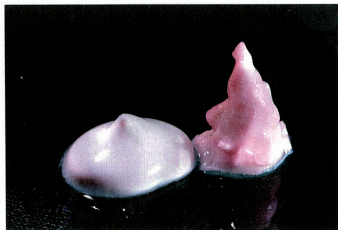
Fig. 7 Raffronto del comportamento di modellazione tra ceraMotion (a destra) e un'altra ceramica dentale.
