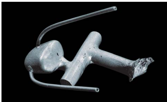
Abb. 4: Gegossenes Brückenglied mit Sauglunker trotz eines Gussreservoirs, Vorwärmtemperatur 950 °C.
