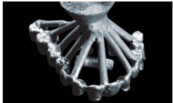
Abb. 8: Gusskanalanlage für eine weitspannige Brücke.
