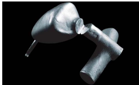
Abb. 5: Gegossenes Brückenglied ohne Gusslunker mit verändertem Gussreservoir, Vorwärmtemperatur 800 °C.
