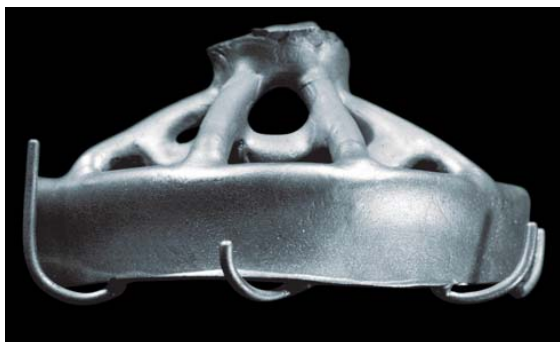
Abb. 2: Testguss „Steg“ mit glatter Gussoberfläche, Vorwärmtemperatur 800 °C.
