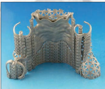
▲ Abb. 6 „Modellgussgerüst“ aus remanium star, Herstellung durch lasercusing (Fa. Concept-Laser, Lichtenfels)
