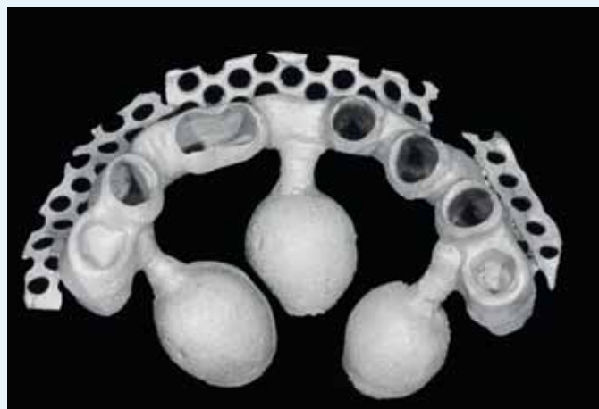
Fig. 5 Fusione grezza in sperimentata lega remanium.
