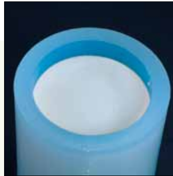
Fig. 11: il rivestimento colato fino alla linea di demarcazione
