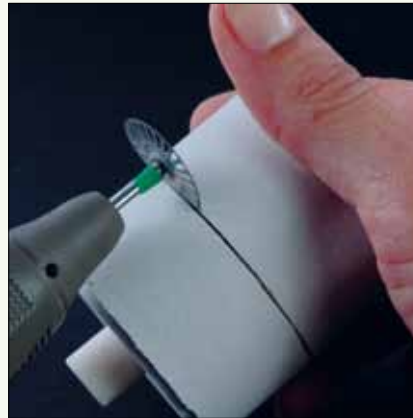
Fig. 19: incisione del cilindro con un disco separatore
