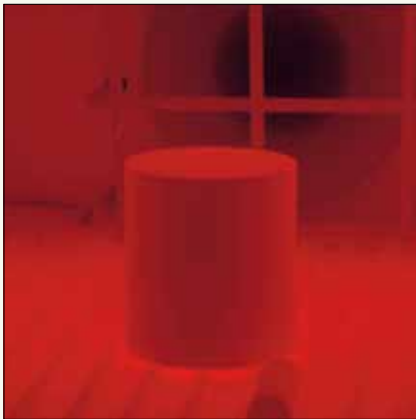
Fig. 15: il cilindro nel forno di preriscaldamento
