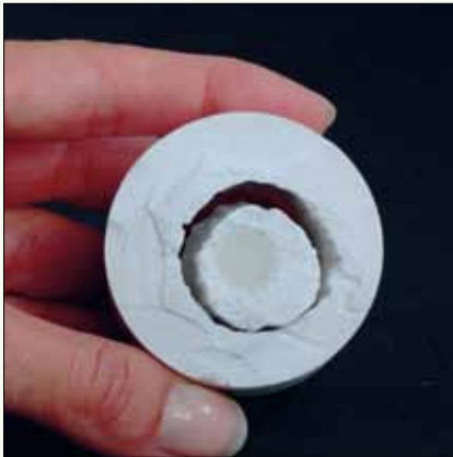
Fig. 22: sabbiatura dell'interno cilindro
