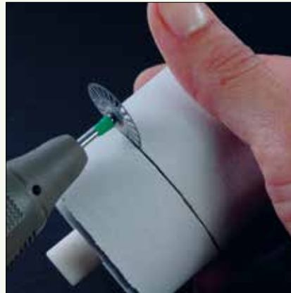
Abb. 19: Eintrennen mit Trennscheibe
