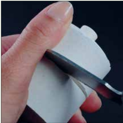
Abb. 20: Auftrennen der Muffel
