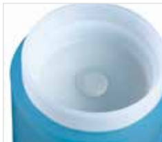
Fig. 6c) Après la prise du revêtement, démouler le cylindre.
