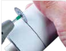
Abb. 7b) Mit Trennscheibe ringsum Sollbruchlinie erzeugen.
