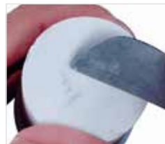
Fig. 6d) Pareggiare le superfici del cilindro con un coltello per gesso.
