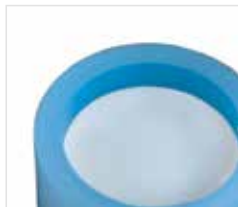
Fig. 6a) Versare il rivestimento nel cilindro con una leggera vibrazione.
