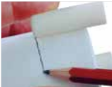
Fig. 7a) Après refroidissement, marquage de la longueur du piston de pressée sur le cylindre.
