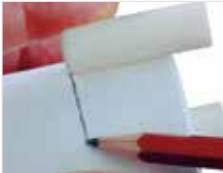
Abb. 7a) Nach Abkühlung Markieren der Länge des Pressstempels auf der Muffel.
