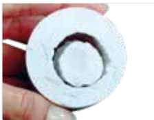
Fig. 7e) Desmuflado basto con \text{Al}_2\text{O}_3 a 4 bar de presión. Chorreado preciso y cuidadoso con perlas de vidrio (tamaño de grano medio) a 2 bar de presión.
