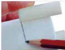
Fig. 7a) Después de que se enfríe, marque la longitud del troquel para el cono de prensado en el cilindro.
