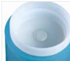
Abb. 6c) Nach Abbinden der Einbettmasse Muffel entformen.
