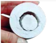
Fig. 7e) Démoulage grossier avec \text{Al}_2\text{O}_3 à une pression max. de 4 bar. Sablage de précision avec précaution avec des billes de verre, granulométrie moyenne et pression max. de 2 bar.
