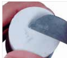
Fig. 6d) Lisser les irrégularités avec un couteau à plâtre.
