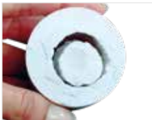
Abb. 7e) Grobausbettung mit Al 2 O 3 bei max. 4 bar Druck. Vorsichtiges, präzises Abstrahlen mit Glasperlen (mittlere Körnung) bei max. 2 bar Druck.
