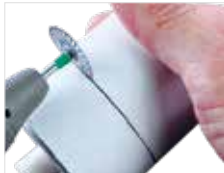
Fig. 7b) Créer une ligne de rupture sur le pourtour avec un disque de séparation.
