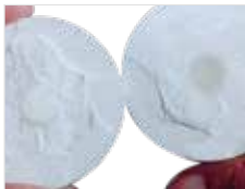
Fig. 7d) El cilindro cortado en el punto de transición del troquel al cono de prensado.
