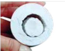
Fig. 7e) Prima smuffolatura con \text{Al}_2\text{O}_3 con max. 4 bar di pressione. Sabbiare cautamente con perle autolucidanti (grana media) a max. 2 bar di pressione.
