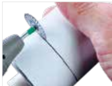
Fig. 7b) Za pomocą tarczy tnącej wytworzenie linii łamania na całym obwodzie.
