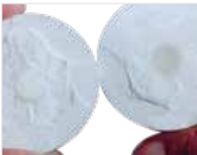
Abb. 7d) Getrennte Muffel am Übergang von Stempel zum Presskegel.
