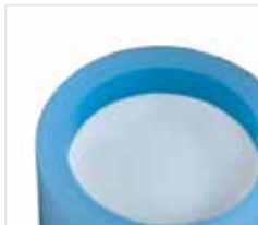
Ryc. 6a) Wlanie masy osłaniającej do mufli z lekkimi wibracjami.
