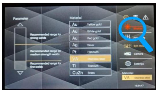
Le laser est équipé d'un obturateur de sécurité qui doit être ouvert à chaque redémarrage. Pour ce faire, activer l'icône à l'écran. Le laser n'est prêt à être utilisé que si l'obturateur de sécurité est allumé en vert.
