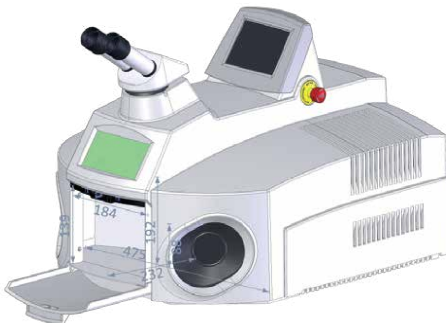
Figure 6 : Dimensions de la chambre de soudage
