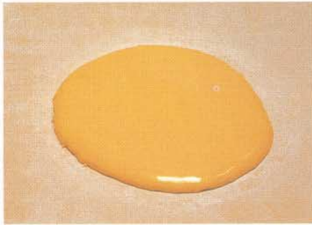
FIG. 3 - Plaque de vitrocéramique après traitement de thermocoloration.
