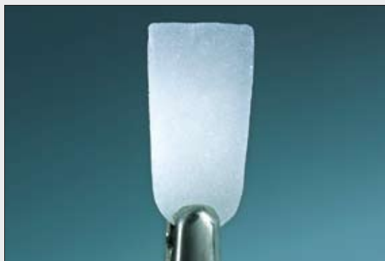
Fig. 1a : Echantillon avec une cuisson incorrecte (température trop faible)
