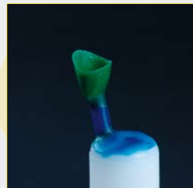
Fig. 3 : Fixation de la tige de coulée sur le socle du cylindre
