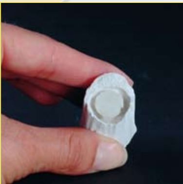
Fig. 7 : Le démoulage par micro-billage
