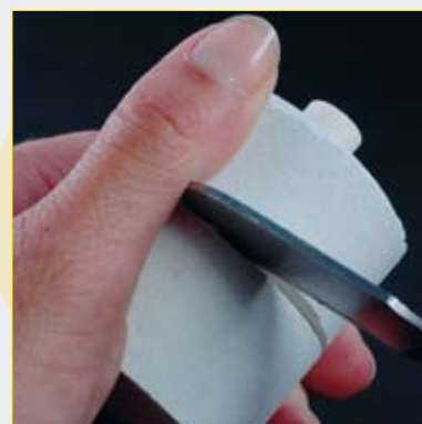
Fig. 3 : Ouverture du cylindre par écartement
