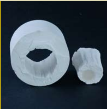
Fig. 6 : Le cœur du cylindre après son extraction
