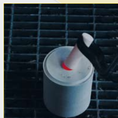
Fig. 3 : La mise en place du piston de pressée
