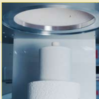
Fig. 5 : Le cylindre juste après la pressée dans le four.
