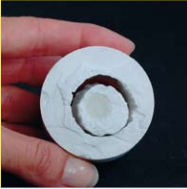
Fig. 5 : On dégage, par sablage, le cœur du cylindre
