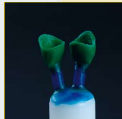
Fig. 4 : Fixation des tiges de coulée sur le socle du cylindre
