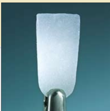
Fig 2 : Echantillon de cuisson avec température de cuisson trop basse
