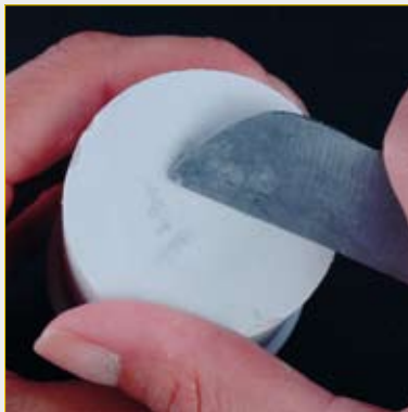
Fig. 10 : Egalisation de la surface d'assise du cylindre en revêtement
