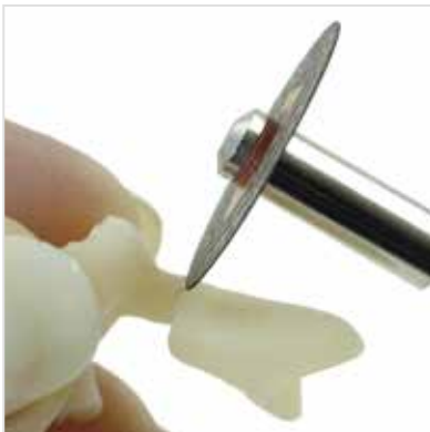
Désolidarisation du conduit de coulée.
