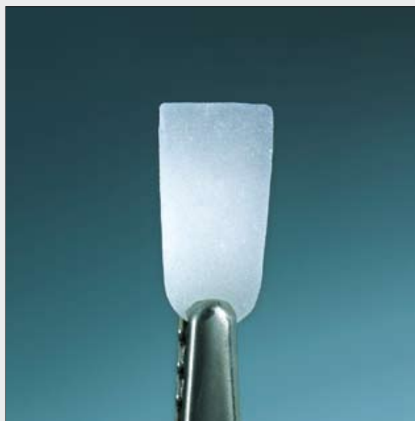
Fig. 2 : Echantillon avec une cuisson incorrecte (température trop faible).
