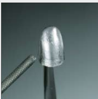
Fig. 1 : Pour la préparation de l'armature, nous conseillons de travailler à l'aide de fraises en carbure de tungstène.
