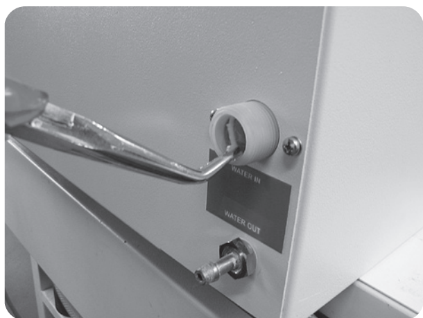
Fig. 5: Situación de montaje del filtro del agua a la conexión de agua corriente
