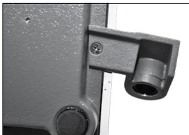
Conectar y colocar los electrodos manuales.
