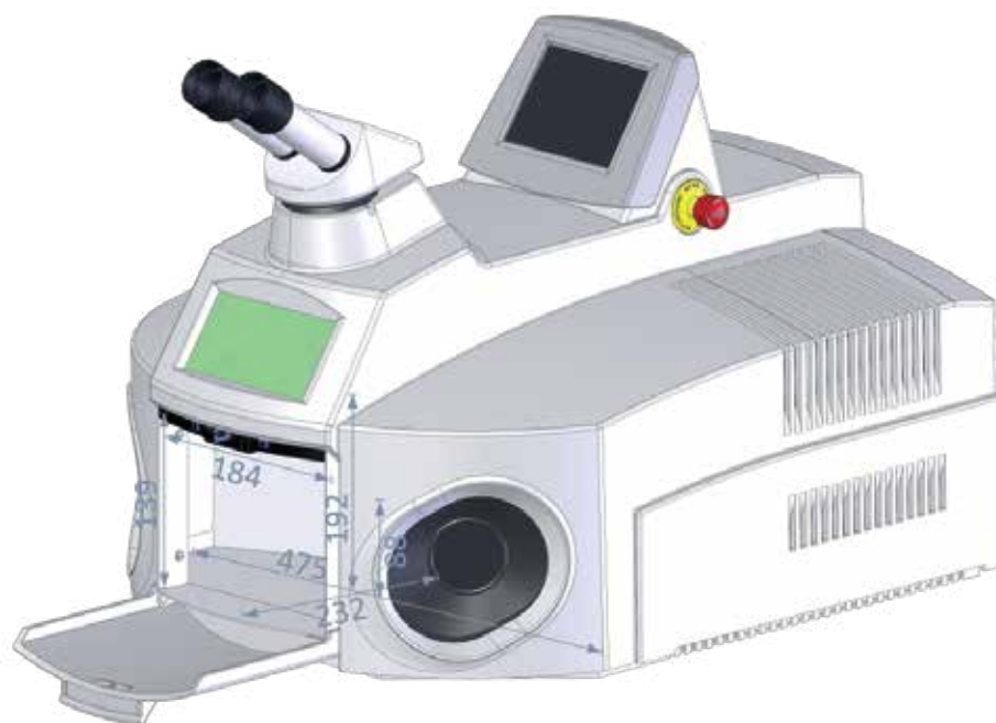
Figura 6: Dimensiones de la cámara de trabajo
