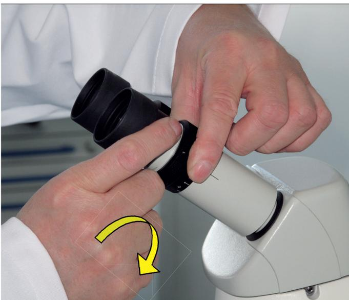
**Figura 14: Alinear la cruz reticular con la escala lineal**
