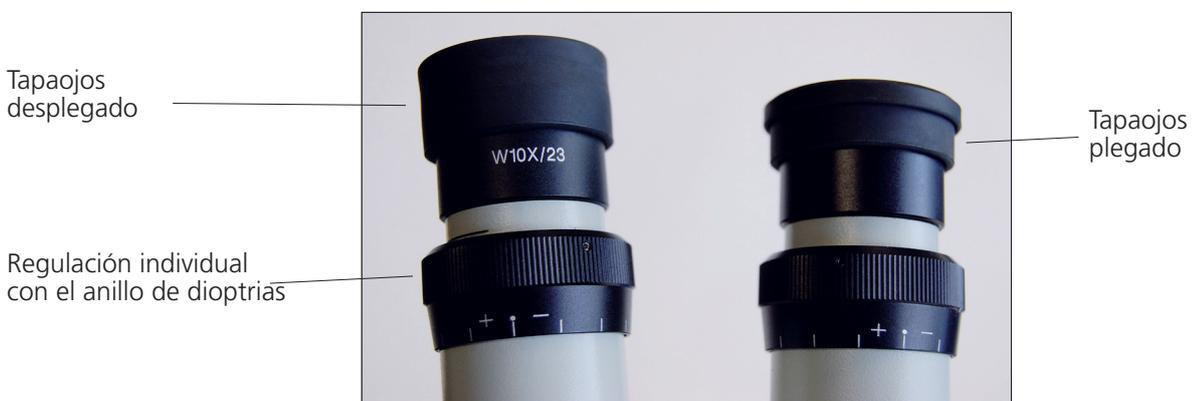
**Figura 12: Regulación de oculares en el microscopio**
