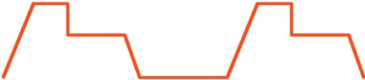
**Figura 10: Forma del impulso con la regulación "impulso escalonado"**
