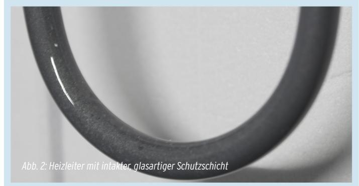
Abb. 2: Heizleiter mit intakter glasartiger Schutzschicht
