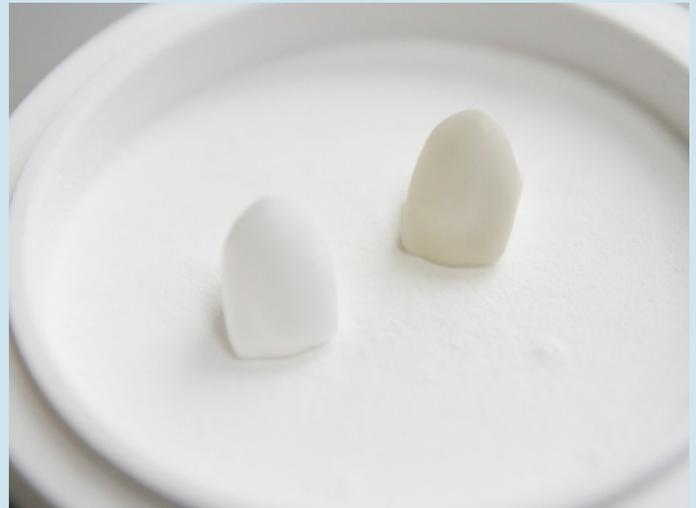
Abb. 1: Beispielhafte Verunreinigung an weißem Material. Die linke Krone ist in einer reinen Ofenatmosphäre gesintert, die rechte Krone in einer kontaminierten Umgebung. Die Aufnahme färbender Metallionen ist deutlich sichtbar.
