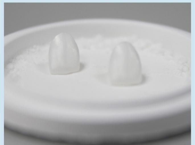
Abbildung 7: Sinterschale mit **Nacera® Clean** nach dem Sintern
