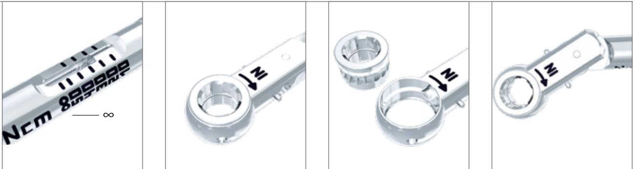
Der Druckpunkt für eine exakte Drehmomentauslösung ist ausschließlich am Kopf der Einstellmutter. Bei Erreichen des eingestellten Drehmomentes knickt die Skalenhülle um die Achse im Ratschenkopf. Die Auslösung erfolgt hör- und fühlbar. Nach der Auslösung des Drehmomentes **NICHT** mehr weiter drücken – die Ratsche kann beschädigt werden.
