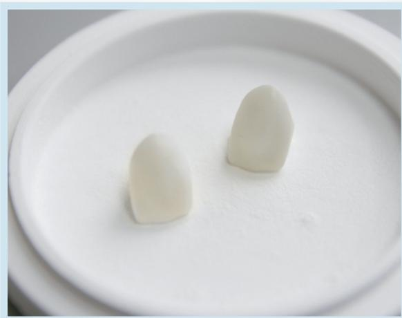
Abbildung 1: Sinterergebnis ohne Nacera<sup>®</sup> Clean Anwendung
