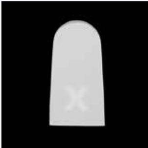
Abb. 5: unterbrannte Brennprobe
