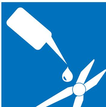
Trattare il perno e gli inserti in tungsteno della pinza con olio lubrificante (REF: 055-201-00).
