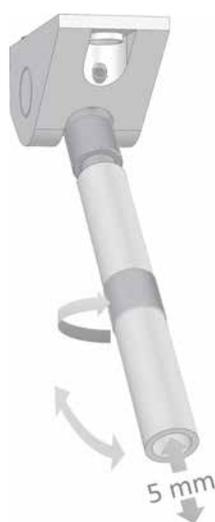
Lors du soudage de matériaux uniques, par ex. le titane, il est recommandé que les deux buses pour gaz de protection se trouvent à la même position, afin de protéger la soudure de l'oxydation aussi bien à l'avant qu'à l'arrière.
