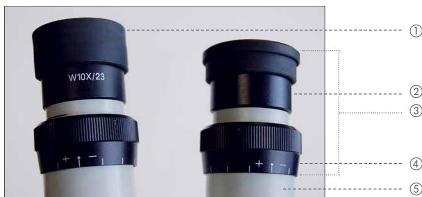
**Figure 17 : Oculaire et œillette de l'embout de microscope standard**
