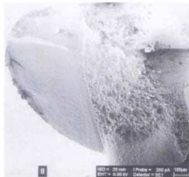
Abb. 9c Ermüdungsbruch an einem Remanium-Draht.
