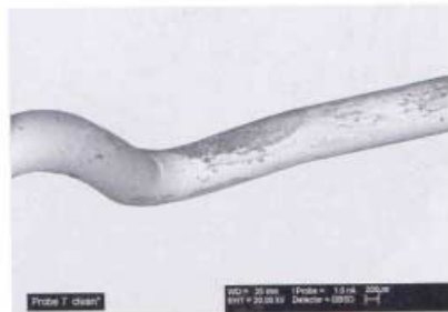
Abb. 8 Bearbeitungsbedingte Oberflächenschädigungen (Schleifspuren und Riefen) an Drähten bei kieferorthopädischen Apparaturen.
