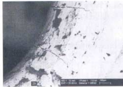
Abb. 6a und b Bruch- und Rissbildung durch Ermüdung bei einer zu eng gewickelten Schenkelfeder (b = Ausschnitt aus a).
