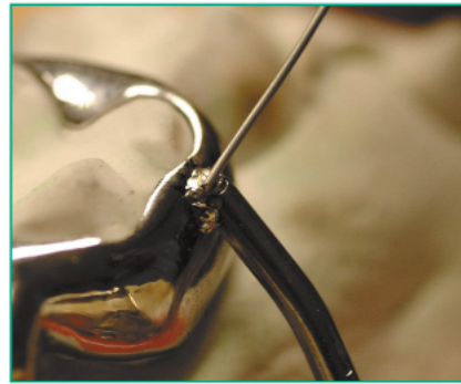
Abb. 11: Schweißen mit Schweißzusatzmaterial
