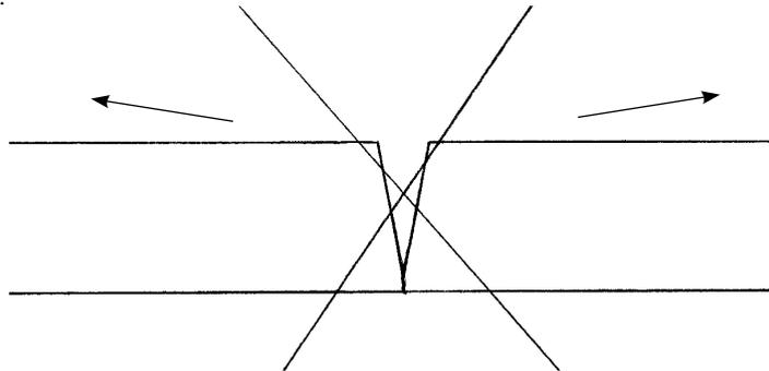
Hier entsteht unweigerlich ein Verzug der Laserschweißung, da die Schweißung oben auf Grund des größeren Spaltes stärker kontrahiert.
