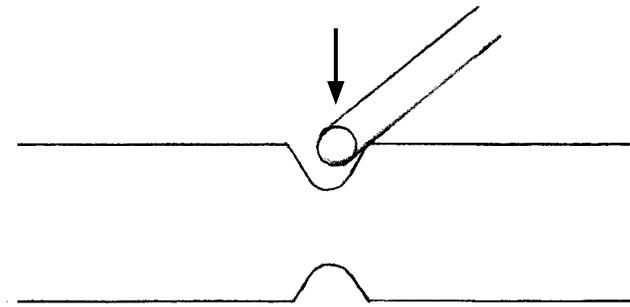
Zusatzmaterial der gleichen Legierung (0,35 mm bis 0,5 mm Draht) wird rings um die Hohlkehle mit niedriger Schweißenergie aufgeschweißt. Es wird dabei soviel Material aufgebaut, dass mindestens der Gesamtquerschnitt des Ursprungmaterials erreicht wird.
