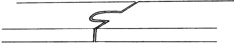
Gleich wie die Stoßflächen gestaltet sind, es muss immer ein gleichgerichtetes Schweißen von der gegenüberliegenden Seite möglich sein. Nur dadurch können auftretende Spannungen ausgeglichen werden.
