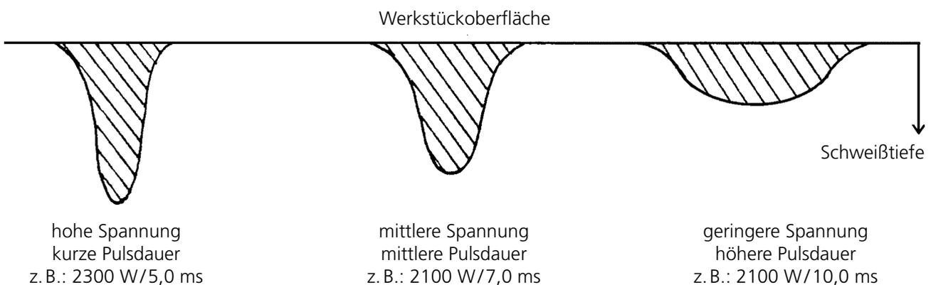
Durch die Einstellung der entsprechenden Schweißparameter können so zum einen massive Elemente wie Unterkieferbügel oder massive Zwischenglieder sicher verbunden werden, da Materialstärken bis ca. 4 mm durch beidseitiges schweißen durchgeschweißt werden können. Auf der anderen Seite sind aber auch feinste Schweißungen wie an Implantaten oder Geschiebeteilen durch Reduzierung der Leistungsabgabe sicher durchführbar.
