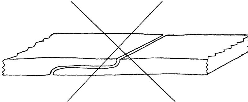
Beim Laserschweißen wird immer ein stumpfer Stoßkontakt gesucht, der ein gegenseitiges Verschweißen von oben und unten ermöglicht.
