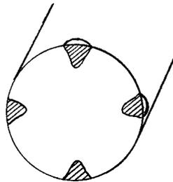
Wie in der Abbildung dargestellt, werden 4 gegenüberliegende Schweißpunkte mit niedriger Energie gesetzt. Je nach Anwendungsfall wird mit einer Schweißtiefe von 0,15 mm bis 0,3 mm gearbeitet.
