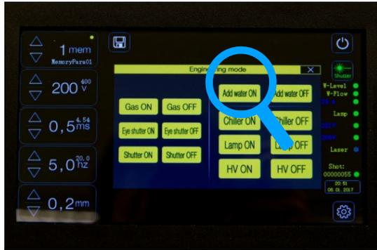
Pour démarrer l'amenée d'eau, activer la touche « Add Water ON » (Ajouter eau MARCHE). La procédure s'arrête automatiquement lorsque le dispositif a été suffisamment rempli d'eau distillée. Puis, retirer la tubulure. Tous les témoins
