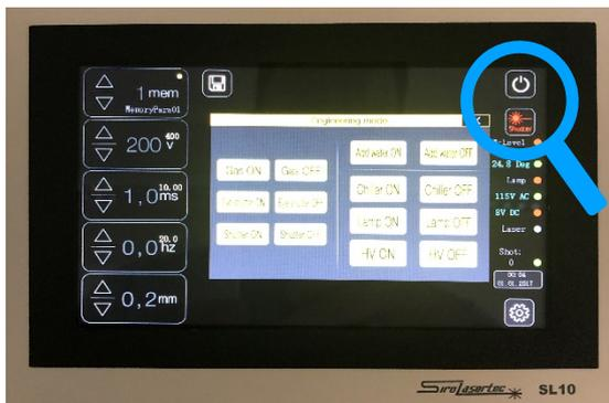
Le laser est équipé d'un obturateur de sécurité qui doit être ouvert à chaque redémarrage. Pour ce faire, activer l'icône à l'écran. Le laser n'est prêt à être utilisé que si l'obturateur de sécurité est allumé en vert.
