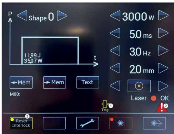
**Figura 21: Pantalla táctil – mensaje de error (=Interlock)**
