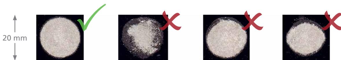
**Figura 26: Impresión del punto focal láser en el papel fotográfico**
