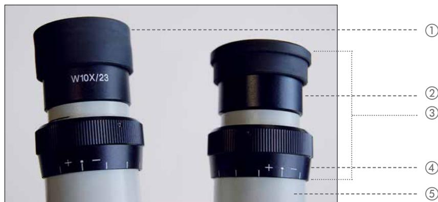
**Figura 17: Ocular y protector ocular del microscopio estándar**
