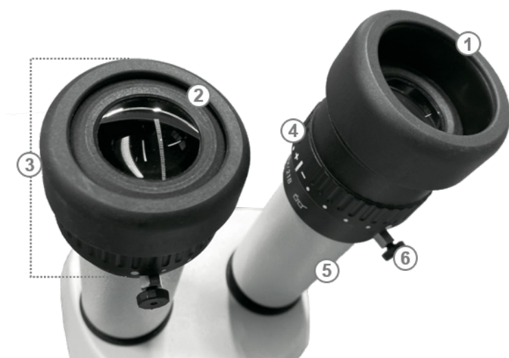
Abbildung 18: Okular und Augenmuschel des Leica-Mikroskop-Aufsatzes
