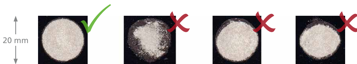
Abbildung 26: Abdruck des Laserbrennflecks auf Fotopapier
