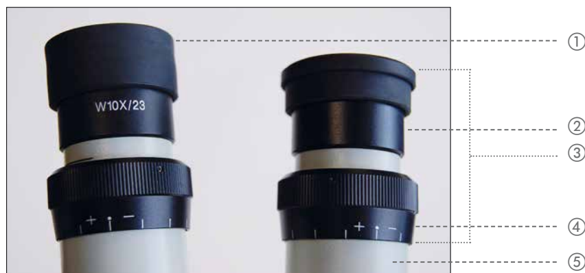
Abbildung 17: Okular und Augenmuschel des Standard-Mikroskop-Aufsatzes
