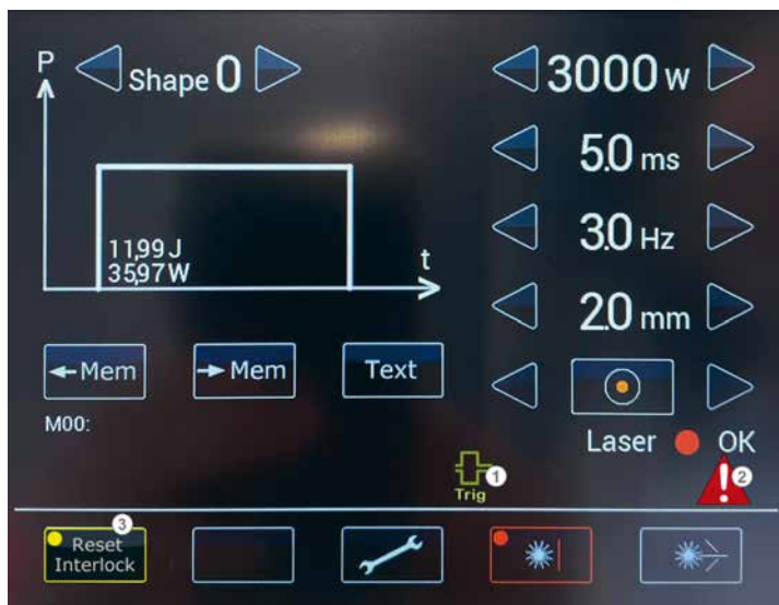
Abbildung 21: Touchscreen – Fehlermeldung (=Interlock)
