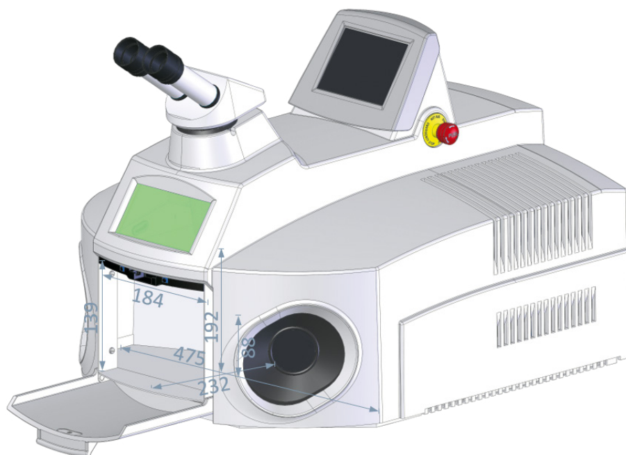
Abbildung 6: Abmessungen der Arbeitskammer
