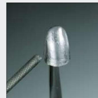
Fig. 1: Estructura repasada con fresa de tungsteno de dentado cruzado antes de chorrear.
