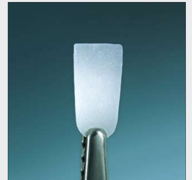
Fig. 2: Prueba de cocción con temperatura demasiado baja
