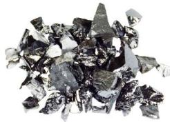
Silizium dient hauptsächlich zur Beeinflussung des Fließverhaltens. Zusätzlich zum Co erhöht es die Leichtflüssigkeit der Schmelze und ermöglicht so das vollständige Ausfließen auch graziler Teile.
