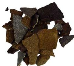
Mangan wirkt beim Schmelzen als Desoxidationsmittel. Es verbindet sich mit Sauerstoff und bildet Oxide, die an die Oberfläche des Schmelzbades steigen. Diese sogenannte Schlacke wird abgezogen und so die Schmelze gereinigt.
