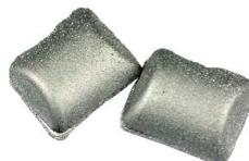
Chrom verleiht Korrosionsfestigkeit. Bei Aufbrennlegierungen bildet es Haftoxide für eine exzellente Metall-Keramik-Verbundfestigkeit.
